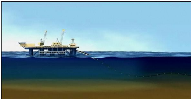
Układanie rurociągu z platformy półzanurzalnej [ http://www.nord-stream.com/ ]
